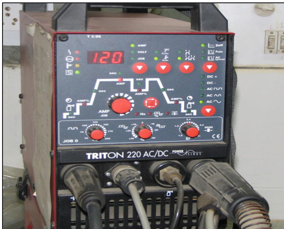
Fig 3.3: TRITON 220 AC / DC (Pulsed GTAW Machine)
