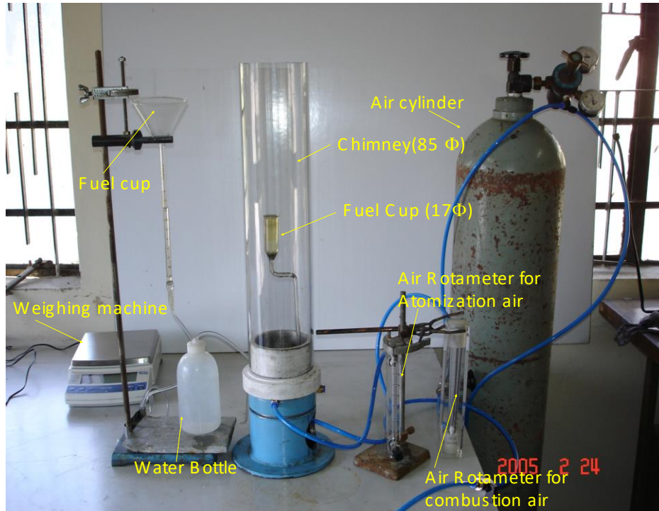
Fig. 4.10 : Modified Cup Burner Apparatus
