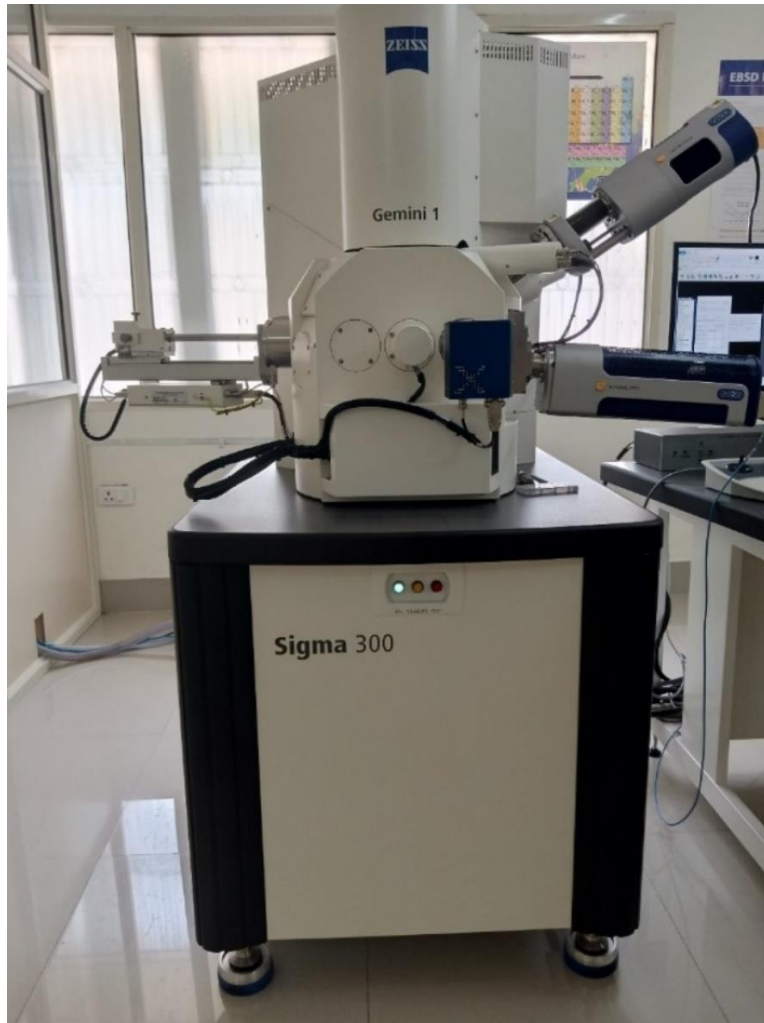
Fig 3.4 ZEISS FESEM (Gemini 1 Sigma 300)
