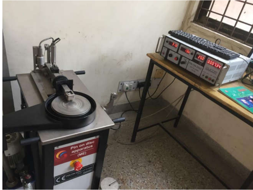
Fig. 3.13. Ducom TR- 201- M4 pin on the disc test machine
