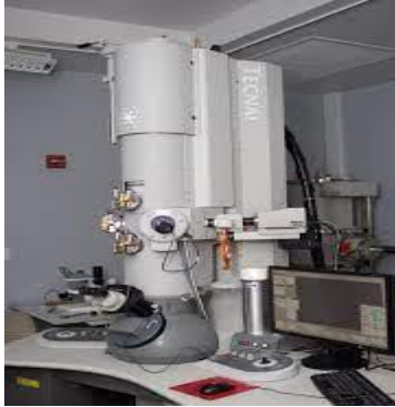
Figure 3.7: Tecnai G2 200 KV HRTEM SEI HOLLAND for TEM analysis
