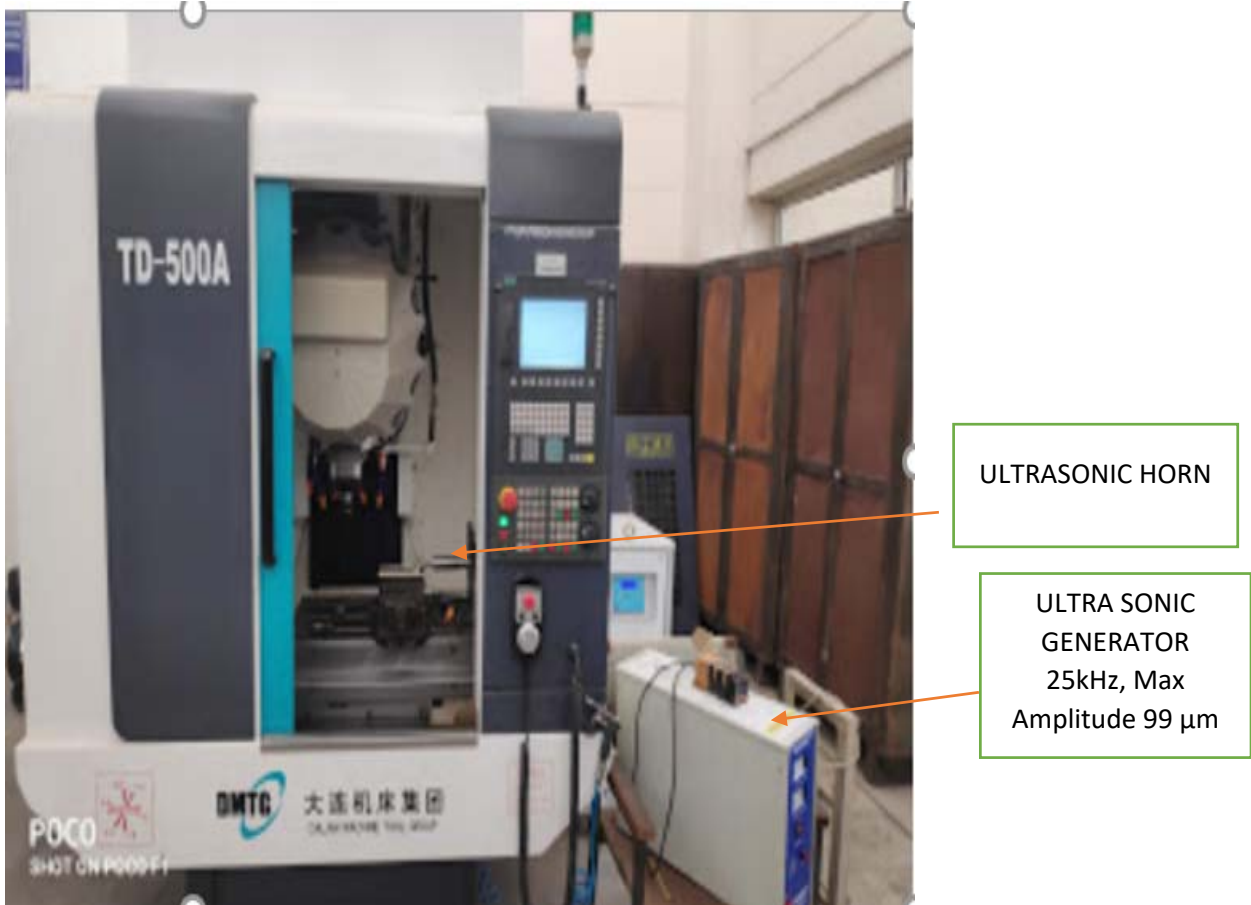
Fig. 7.1. CNC Test Rig
