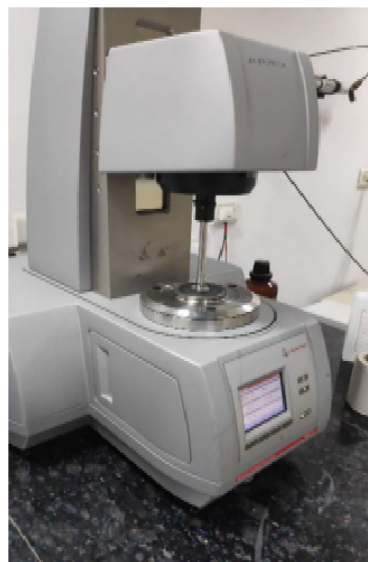
Fig. 3.3. Modular Compact Rheometer [MCR 102] Anton Par
