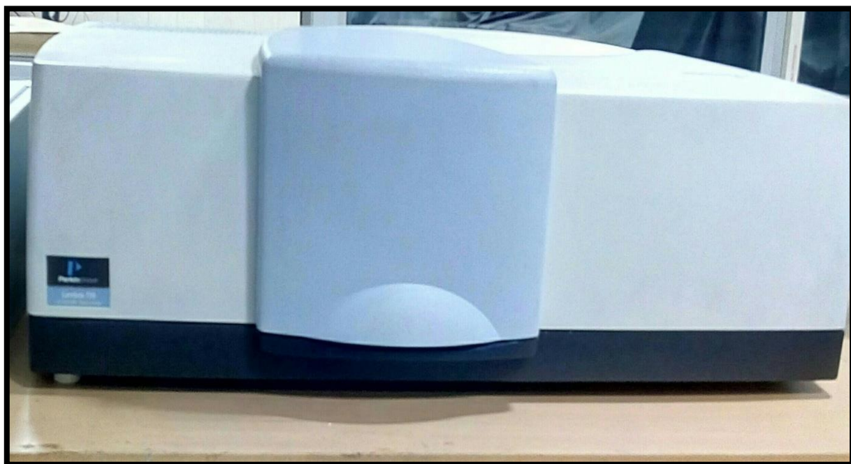
Fig:1.11. UV-VIS/IR spectrophotometer (Model: Perkin Elmer Lambda-750).
