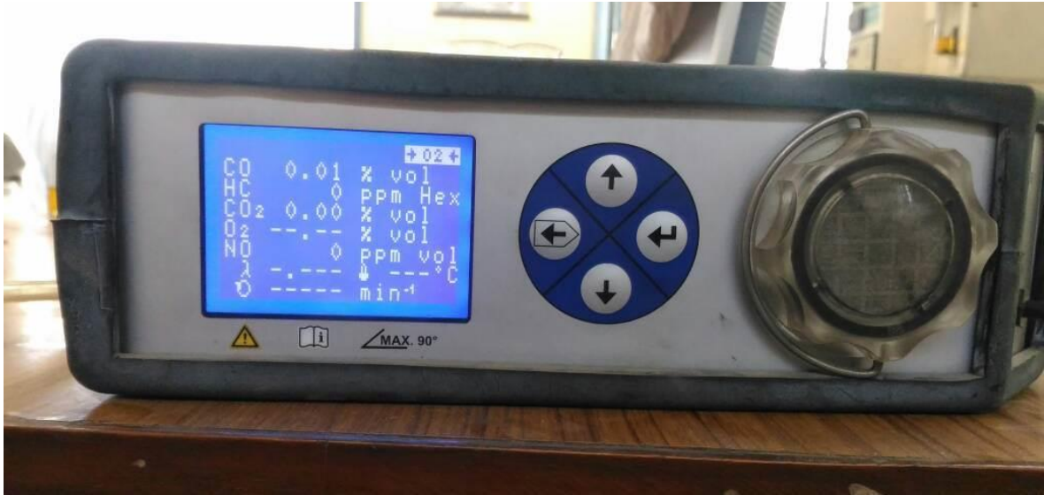
Figure 3.7. Actual setup of multigas analyzer.
