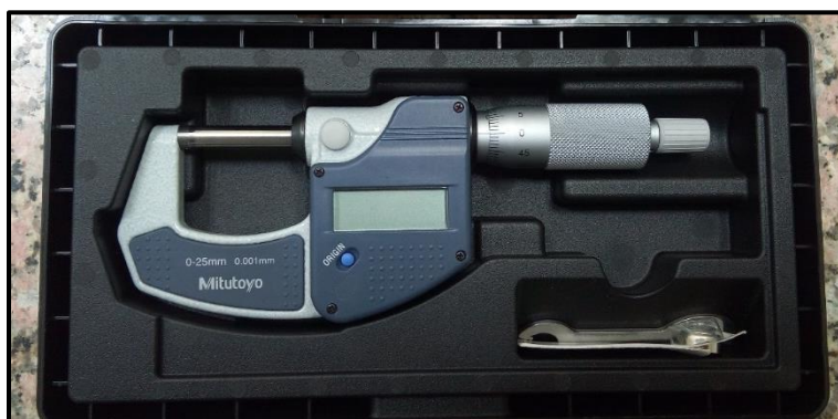
Figure 4.11 Digital micrometer (Mitutoyo MDC 25SX)
