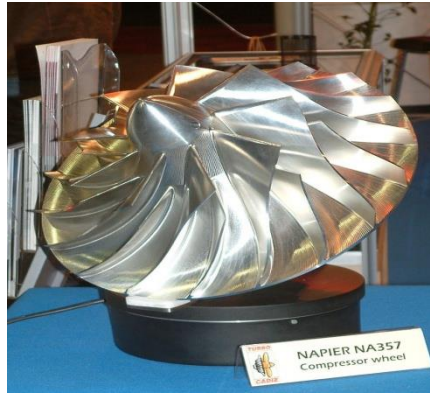
Fig. (5). Centrifugal Compressor
