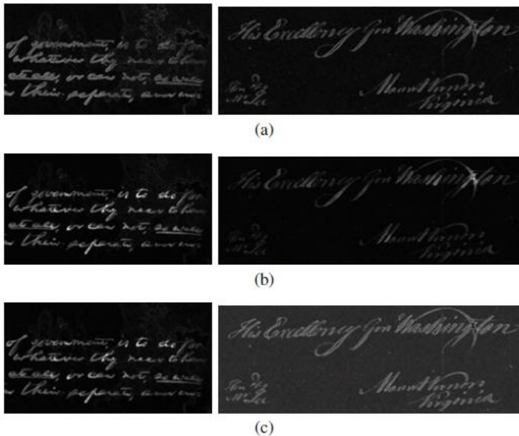
Fig.4.2.1. Formation of contrast image (a)local image gradient.b)local image contrast.c)our method contrast image for fig. 1(b) and (d)
