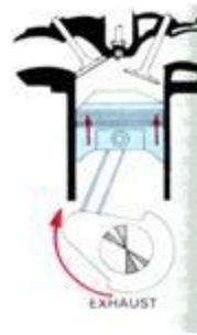
Fig 1.1(d) Exhaust Stroke
