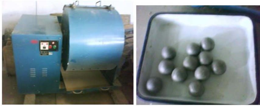
Fig. 19 LOS Angles Abrasion Machine and Spheres
