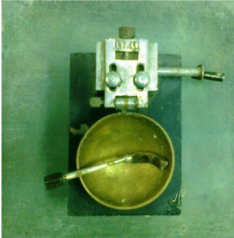
Fig.3.1 A. Casagrande Liquid limit apparatus
