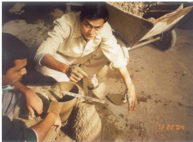
Fig: 1 Slump test
